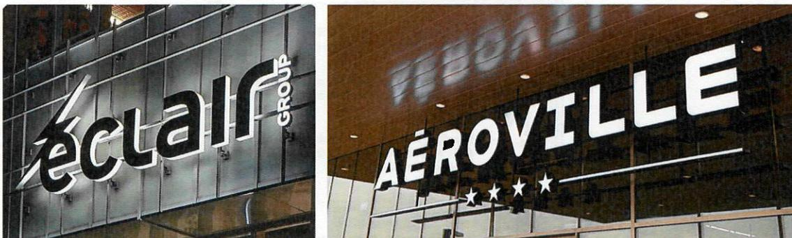
*Exemples d'enseignes en lettres boîtiers rétroéclairées dans l'épaisseur du lettrage*
